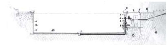
Installationschema für Einbaubecken mit Filterschacht
