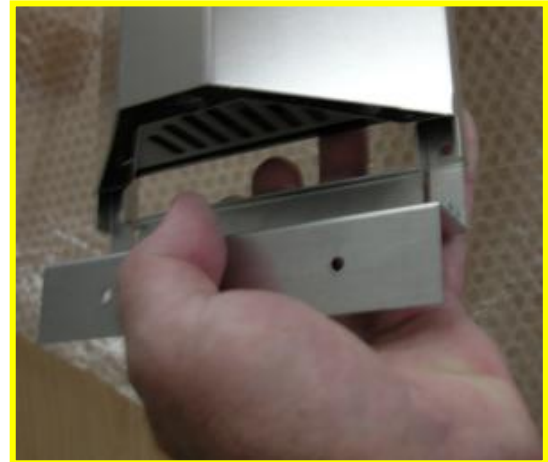
Einsetzen der Montagewinkel
