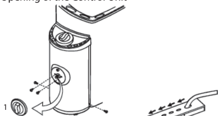
Abb. 3A Fig. 3A Öffnen des Steuergeräts Opening of the Control Unit
