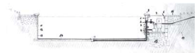
Installationsschema für Einbaubecken mit Filterschacht
